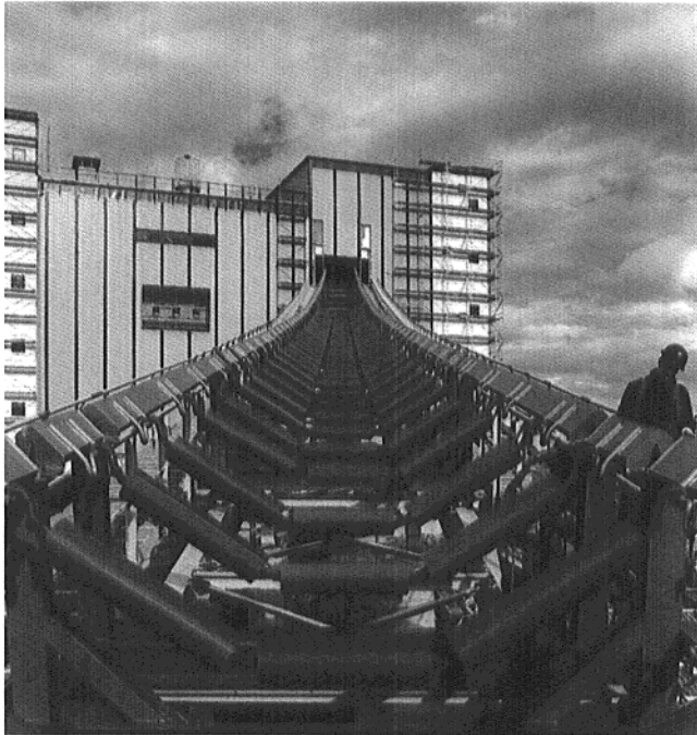
Gurtförderer mit Girlandenrollen Belt conveyor with garland rollers
